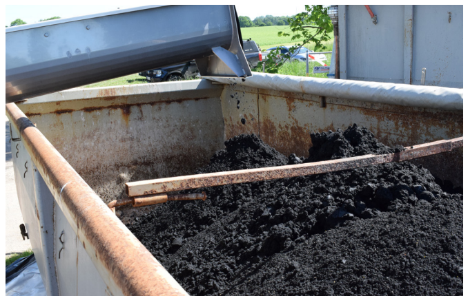
entwässerter Klärschlamm zur thermischen Verwertung
