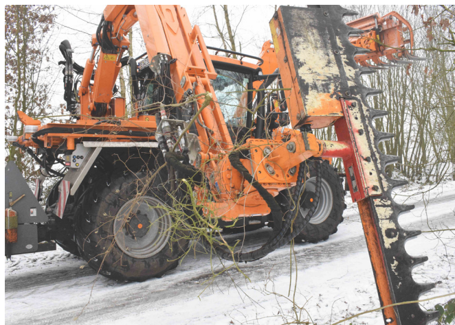
Der Fastrac bei Arbeiten am Knickschnitt
