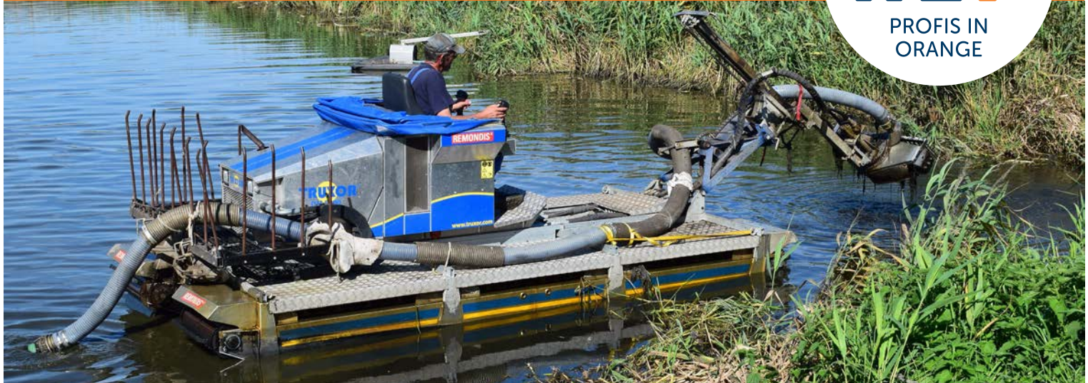
Absaugen des Klärschlammes mittels Amphibienboot
